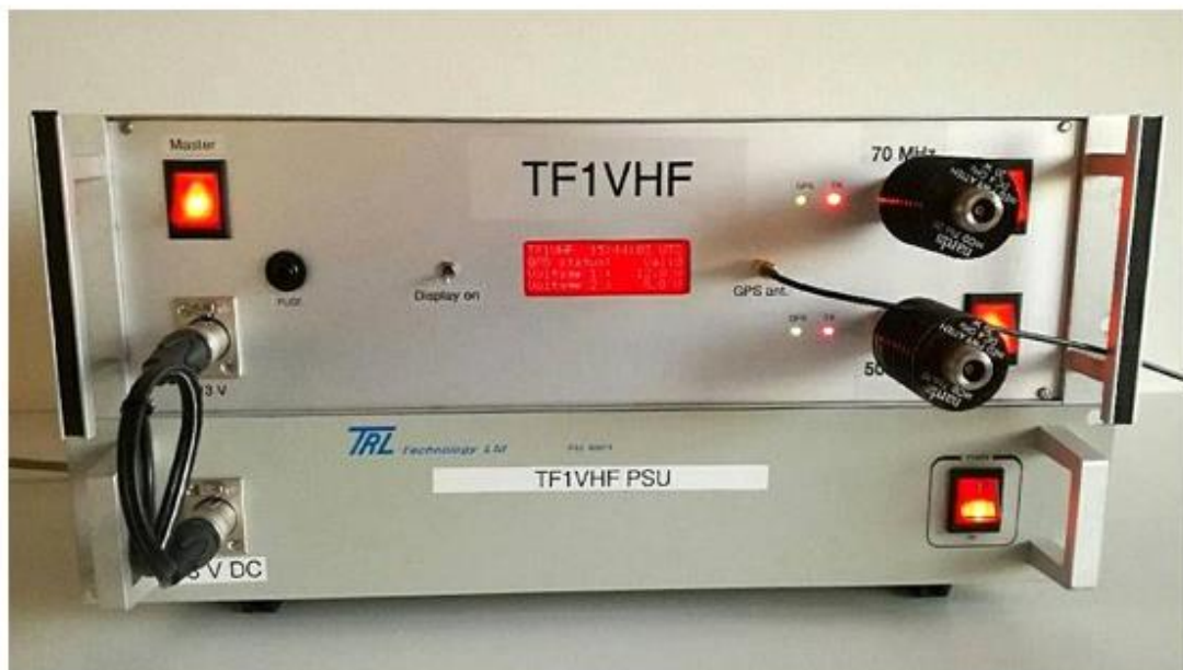
Radióvitarnir eru hannaðir og smíðaðir af hópi radióamatöra í Herlev í Danmörku undir stjórn Bo Hansen OZ2M. Myndin er af búnaðinum fyrir 50 MHz og 70 MHz vitana sem eru í sama kassa. Ljósmynd: TF3ML.
