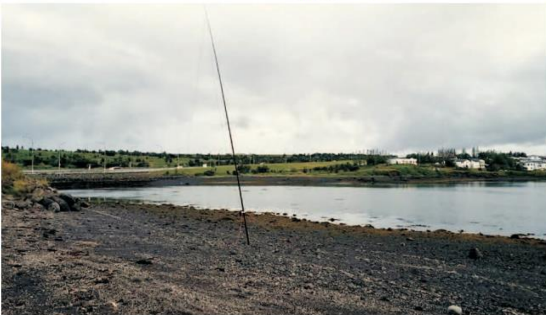
Loftnet TF3HR í útileikunum var útdraganleg glertrefjastöng sem strengt var á "V-á-hvolfi". Á myndinni er Hrafnkell búinn að færa loftnetið niður í fjöru í Fossvoginum.
