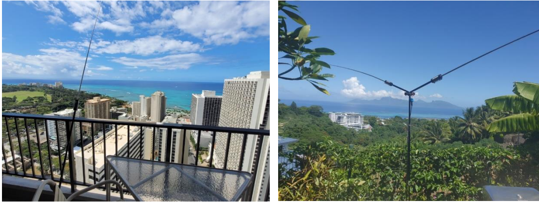
JPC-12 netið sett upp sem stangarloftnet í háhýsi á Hawaii. JPC-7 sett upp sem dípóll á Thaiti. Ljósmynd: TF1OL.
