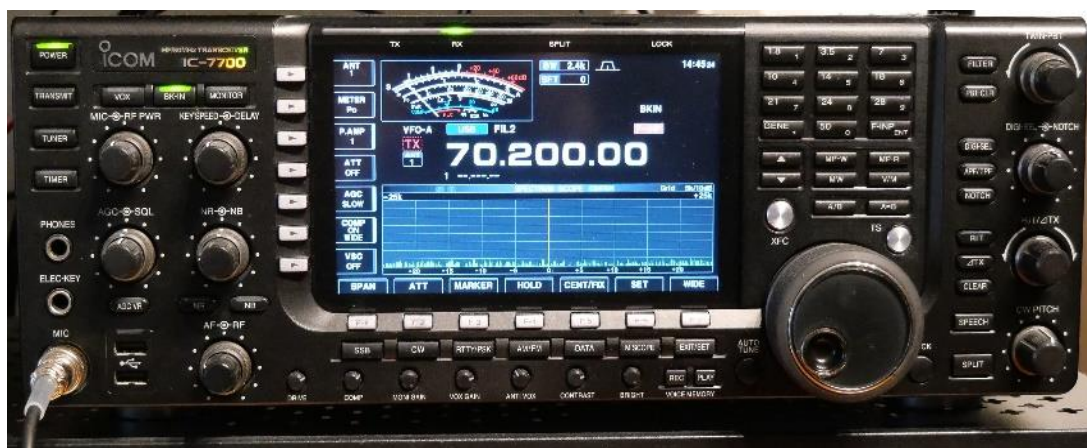
Nýrri HF stöðvar fyrir radióamatöra eru gjarnan búnar 50 og 70 MHz tíðnisviðunum. Þ.á.m. er ICOM IC-7700 sendi-/móttökustöðin sem hefur allt að 200W sendiafl á 4 metrum.
