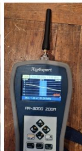
Eftir mynd: Loftnet í resónans á 2M. Neðri mynd: Loftnet sömu gerðar, en mælist ekki í resónans á neinu amatörbandi. (Eins net af samskonar VHF/UHF handstöðvum).
