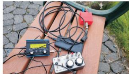
CW/SSB QRP stöð frá QRP LABS með ZM-2 ATM aðlögunarrás frá EMTEC. Einnig á mynd eru GSM sími og mörspöllur (rauðar á lit). Ljósmynd: TF3HR.
