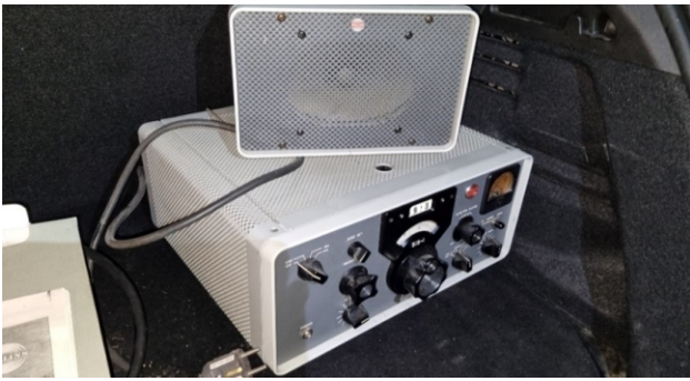
Collins 51S-1 þekur tíðnisviðið frá 0.2-30 MHz í 20 eins megariða þrepum. Collins 312B-4 borðhátalari fylgir viðtækinu. Ljósmynd: TF3HR.
