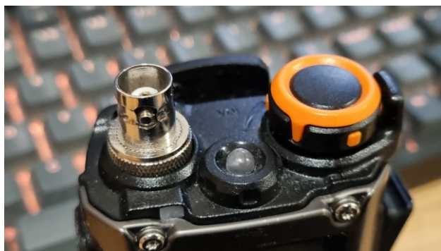
SMA-F í BNC millistykki á Quansheng handstöð höfundar.
