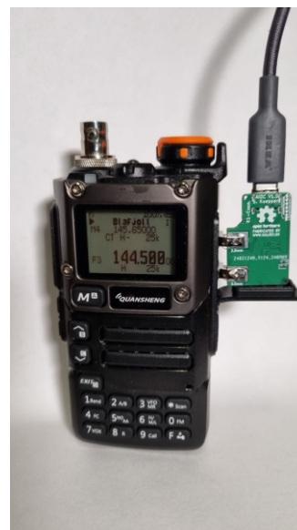
Quansheng handstöð höfundar með AIOC tengi sem stungið hefur verið í samband við K hljóðnema tengið.
