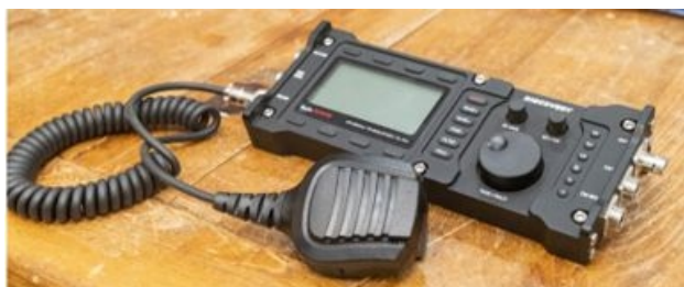
Nýja Discovery TX-500 HF stöð TF3EK frá Lab599. Stöðin vinnur á CW, SSB og DIGI á 160-6 metrum og getur gefið út allt að 10 W.
