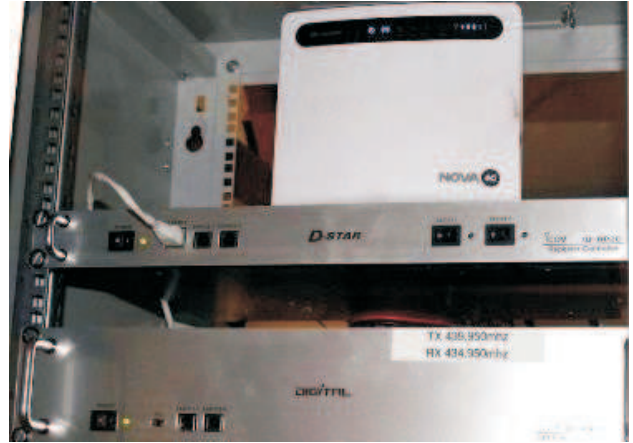
Myndin er af endurvarpanum TF3RPI sem er staðsettur í Bláfjöllum. Ljósmynd: TF1A.
