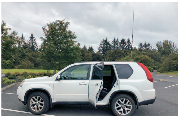
TF3E notaði Diamond RHM-12 HF/VHF/UHF billofnet og Yaesu FT-991A sendi-/móttökustöð í TF útileikunum. Ljósmynd: TF3E.
