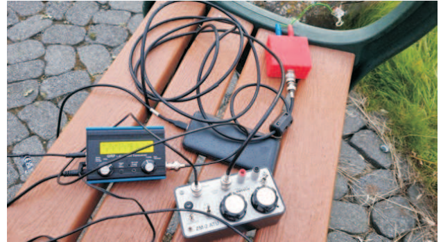
CW/SSB QRP stöð frá QRP LABS með ZM-2 ATM aðlögunarrás frá EMTEC. Einnig á mynd eru GSM sími og mörspöllur (rauðar á lit). Ljósmynd: TF3HR.
