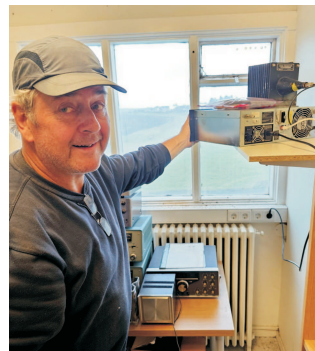
Georg við TF3DMR endurvarpann eftir að hann var búinn að tengja fæðilínuna fyrir UHF loftnetið.
