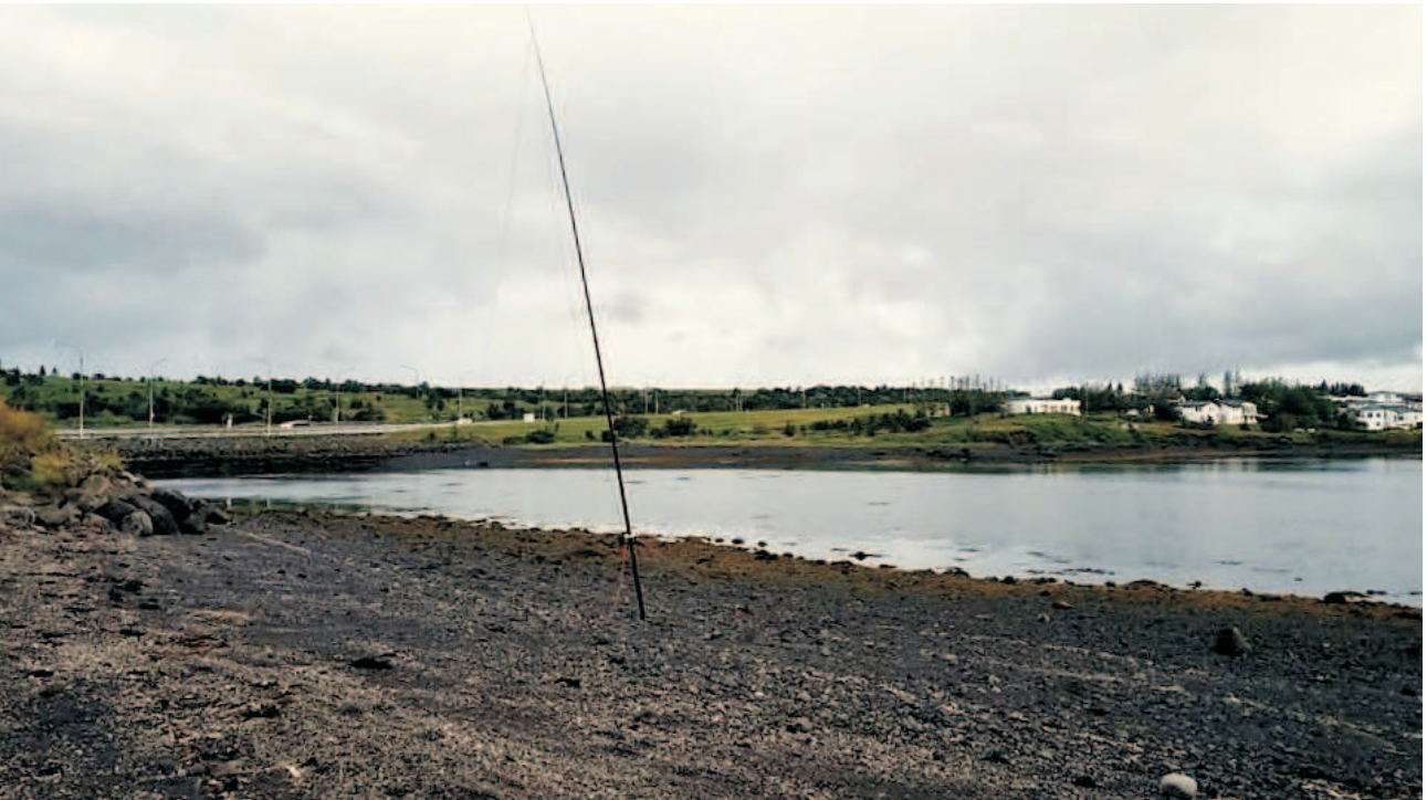
Loftnet TF3HR í útileikunum var útdraganleg glertréffastöng sem strengt var á "V-á-hvolfi". Á myndinni er Hrafnkell búinn að færa loftnetið niður í fjöru í Fossvoginum.
