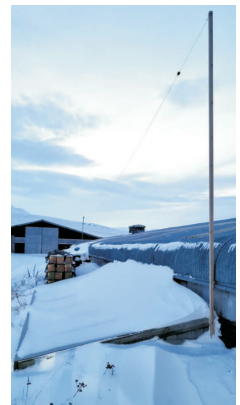
Viðtækið notar 20 metra langt virfloftnet. Ljósmynd. TF4WD.
