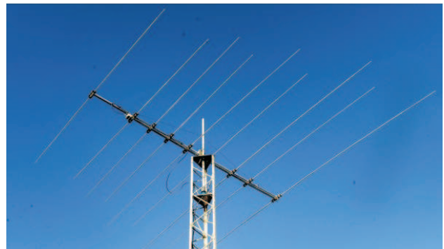
Nýtt OptiBeam OBDYA9-4 Yagi loftnet fyrir 17, 15, 12 og 10 metrana var reist í Skeljanesi s.l. sumar. Ljósmynd: TF3JON.
