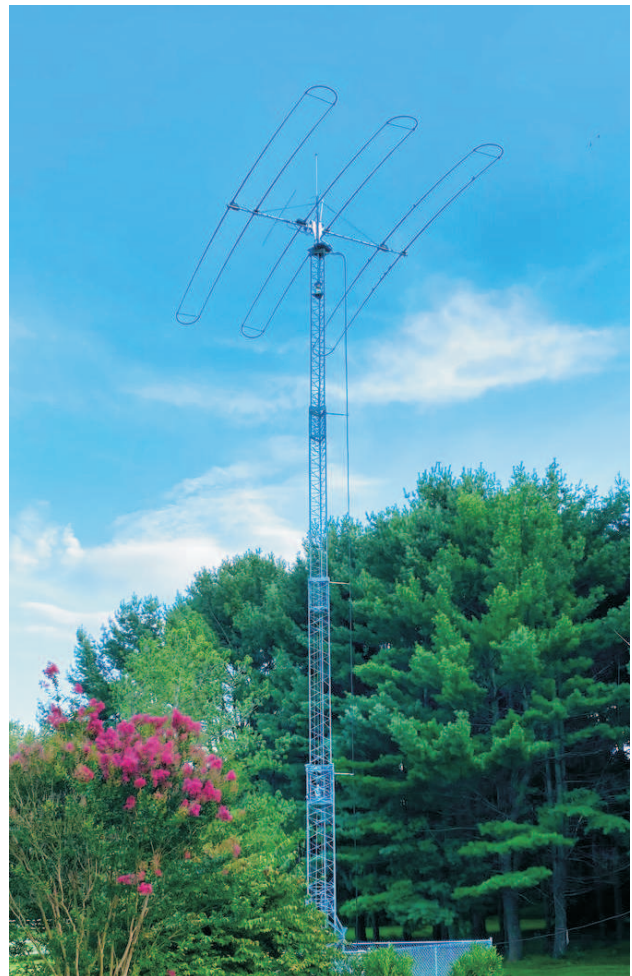
Mynd 5. SteppIr 18E Yagi loftnet.
