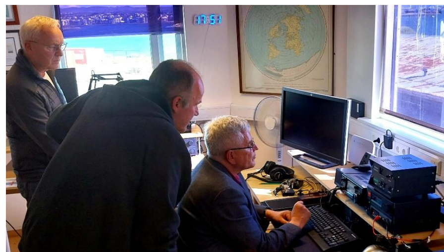
Mikil spennan ríkti í fjarskiptaherberginu kl. 17:51 þegar standbylgjan var prófuð. Og viti menn, uppgefnar standbylgja stóðst á ÖLLUM böndum, þ.e. 1.3 eða betri.
