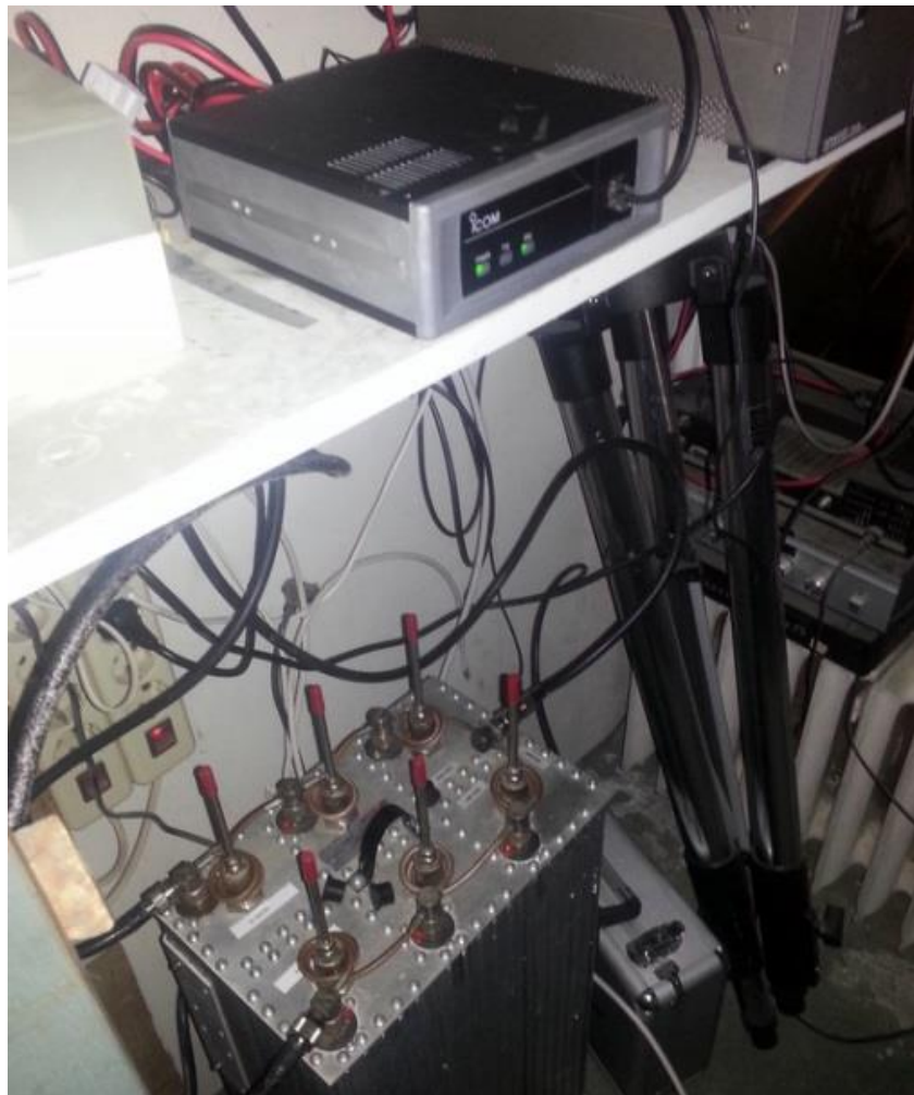
Endurvarpinn TF3RPI er á hillunni, aflagjafi hægra megin við hann og „cavity“ síurnar eru geymdar á gólfinu.
