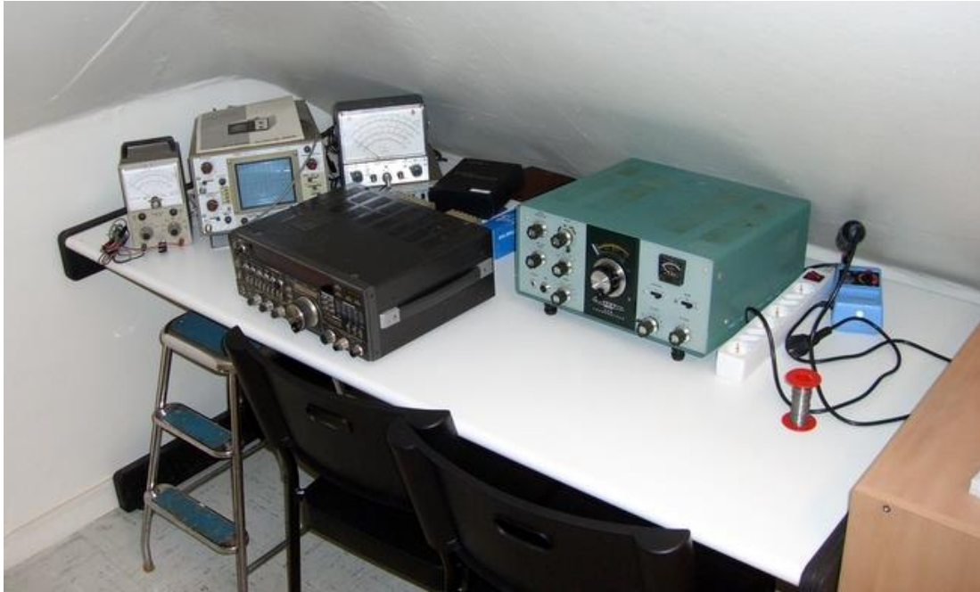
Úr félagsstarfinu. Mörg áhugaverð tæki hafa viðdvöl í smíðaaðstöðu Í.R.A. í félagsaðstöðunni um lengri eða skemmri tíma. Að ofan: Yaesu FT-736R HF sendi-/móttökustöð fyrir HF böndin, auk 50, 144, 430 og 1200 MHz. Hægra megin við hana má sjá Heathkit HW-101 sendi-/móttökustöð fyrir HF böndin.
