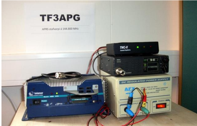
Búnaður APRS stafvarpans TF3APG er staðsettur mitt á milli fjarskiptaborða A og B í fjarskiptaherbergi félagsins í Skeljanesi.
