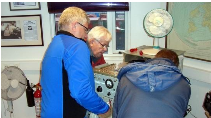
Sæmundur E. Þorsteins-son, TF3UA; Bjarni Magnússon, TF3BM og Baldvin Þórarins-son, TF3-Ø33 renna nýja magnaranum inn í magnarastæðuna í Skeljanesi þann 12. september. Við prófanir kom magnarinn mjög vel út, en hann var prófaður á SteppIR Yagi loftneti félagsins á 10, 12, 15, 17 og 20 metrum.
