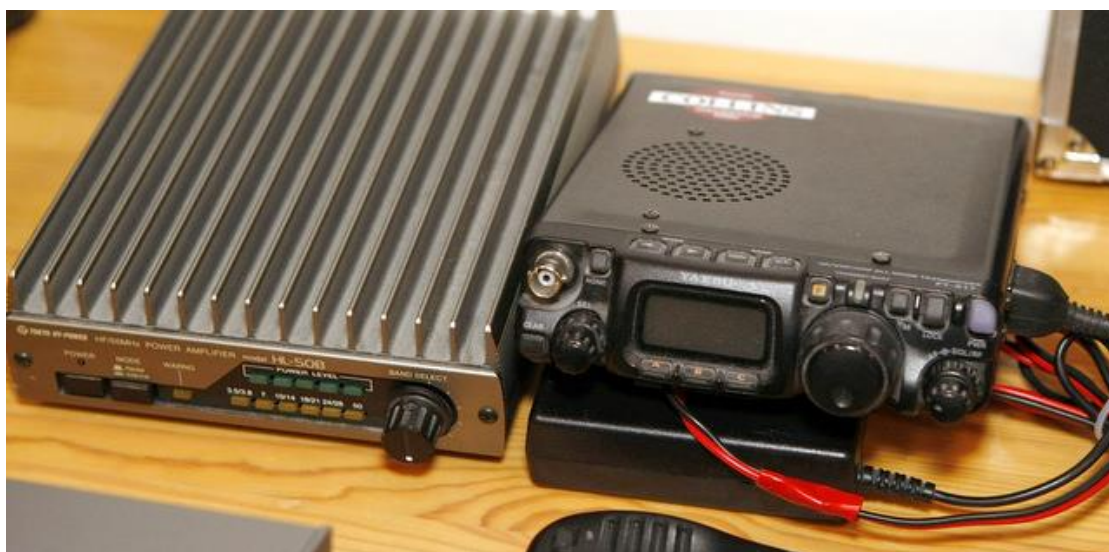
Yaesu FT-817 er 5W CW/SSB sendi-/móttökustöð á HF, auk 50, 144 og 430 MHz. Til hliðar er 50W RF magnari frá Tokyo Hy-Power af gerðinni HL-50B. Búnaðurinn er í eigu Erlings Guðnasonar TF3EE og var til sýnis í Skeljanesi fimmtudagskvöldið 8. mars.
