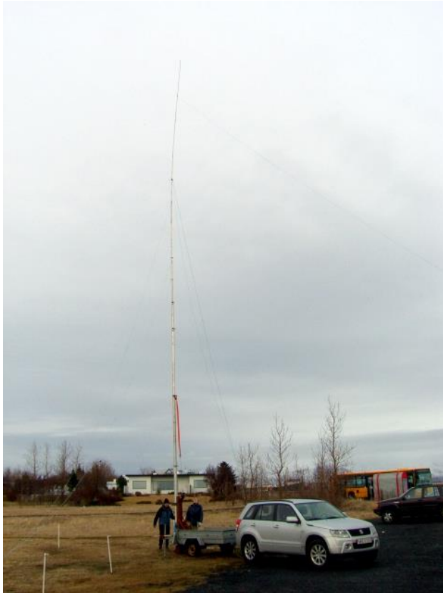
Færanlegt stangarloftnet TF3SG fyrir 80 metrana á bílastæðinu við Skeljanes. Ljósmynd: TF2JB.
