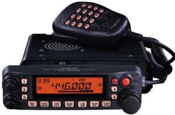
Tíðniyfirferð FT-7900E er valkvæð á 5/10/12.5/15/20/25/50 eða 100 kHz. Sendirinn dregur mestan straum á 70 cm, eða 9,5A.
