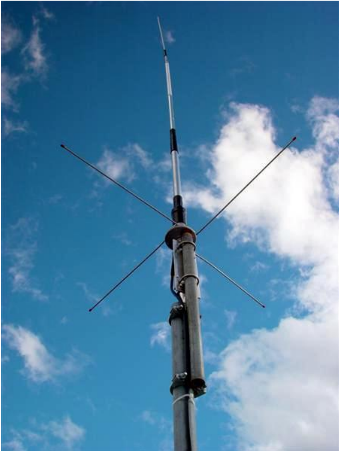
Loftnetið við TF3RPC er Hustler G6-144B frá New-Tronics. Loftnetið er sérstaklega smíðað fyrir endurvarpsstöðvar og hefur 6 dB ávinning yfir tvípól. Ljósmynd: Sigurður Harðarson TF3WS.
