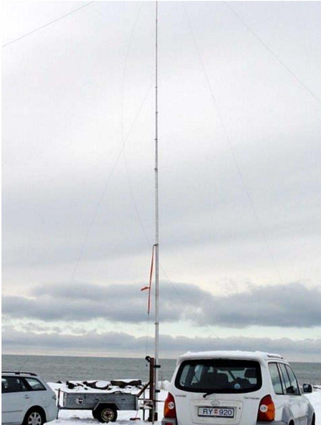
21 metra stöngin fyrir 80 metra bandið uppsett fyrir utan félagsaðstöðu í.R.A. í Skeljanesi í RDXC keppni. Ljós.: TF3SA.
