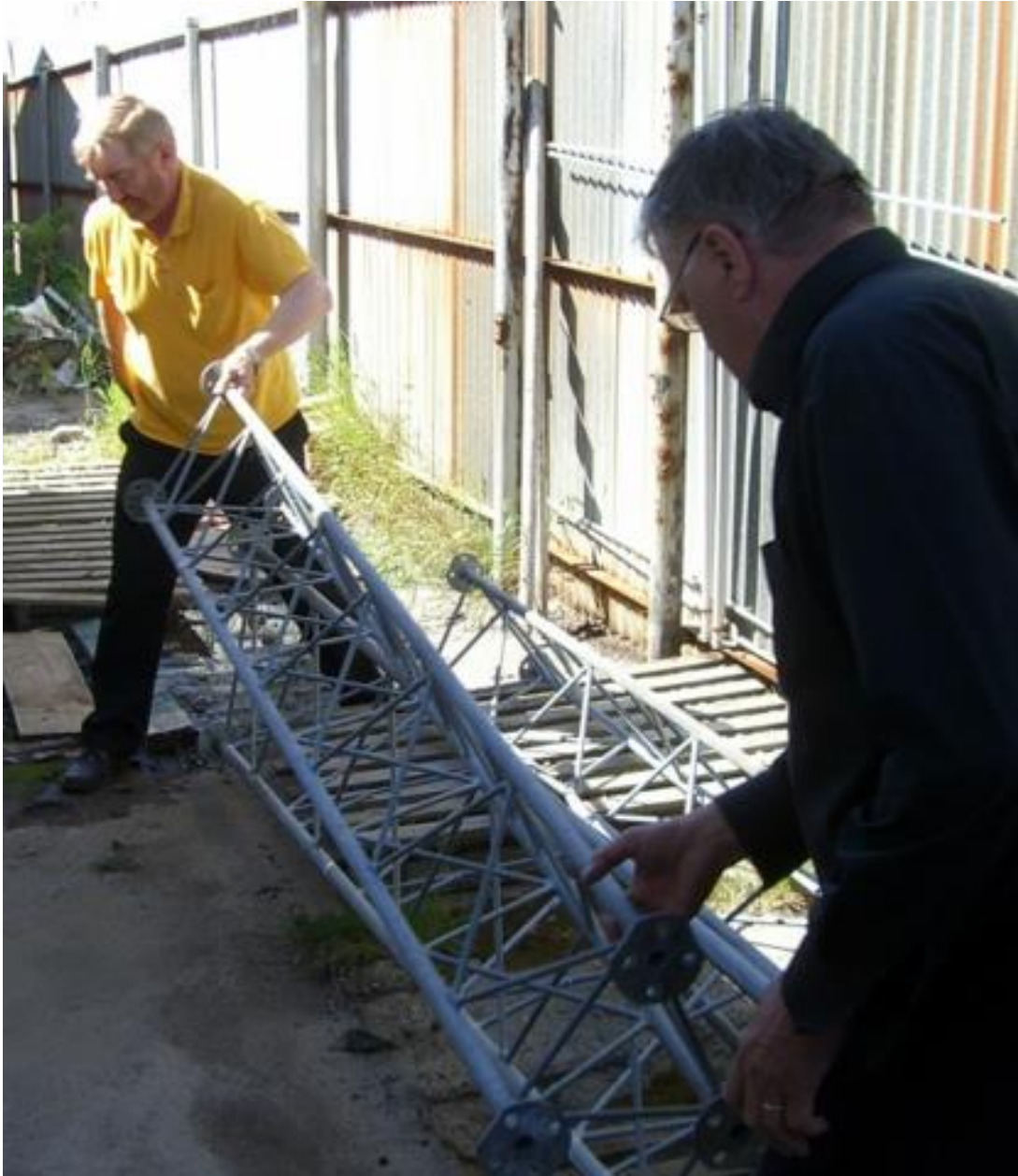
TF3BJ og TF3G ganga frá turneiningum. Turninn er í fimm einingum, 15 metra hárr, vandaður og „galvaniseraður“.
