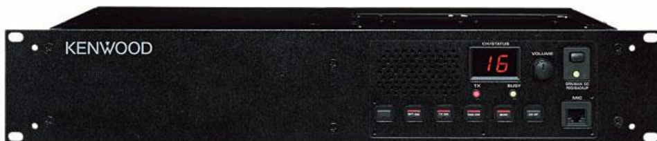
TF3RPC er búinn endurvarpsstöð er af gerðinni Kenwood TKR-750.
