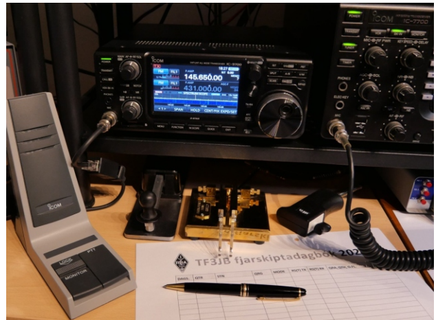
Fjarskiptaaðstaða TF3JB: Icom IC-9700, Icom SM-26 borðhljóðnemi og Diamond X30A VHF/UHF húsloftnet. Ljósmynd: TF3JB.
