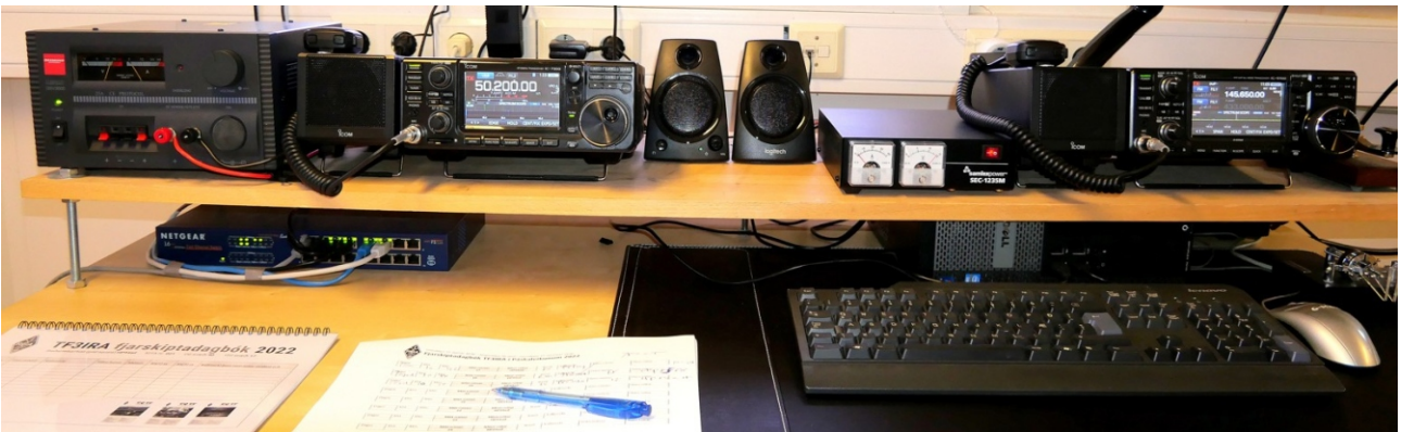
Icom IC-7300 stöð TF3IRA var notuð í Páskaleikunum á 50 og 70 MHz á SSB og Icom IC-9700 [lánsstöð] var notuð á 144 og 433 MHz á FM og SSB. Diamond X-700HN VHF/UHF húsloftnet var notað á 2m og 70cm en stutt stangarnet á 4m og 6m. Ljósmynd: TF3JB.
