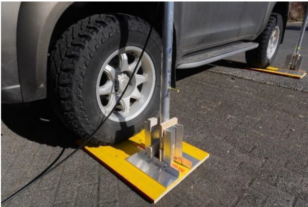
Fötur fyrir loftnetsstöng festur á planku bæði fyrir fram- og afturhjól.
