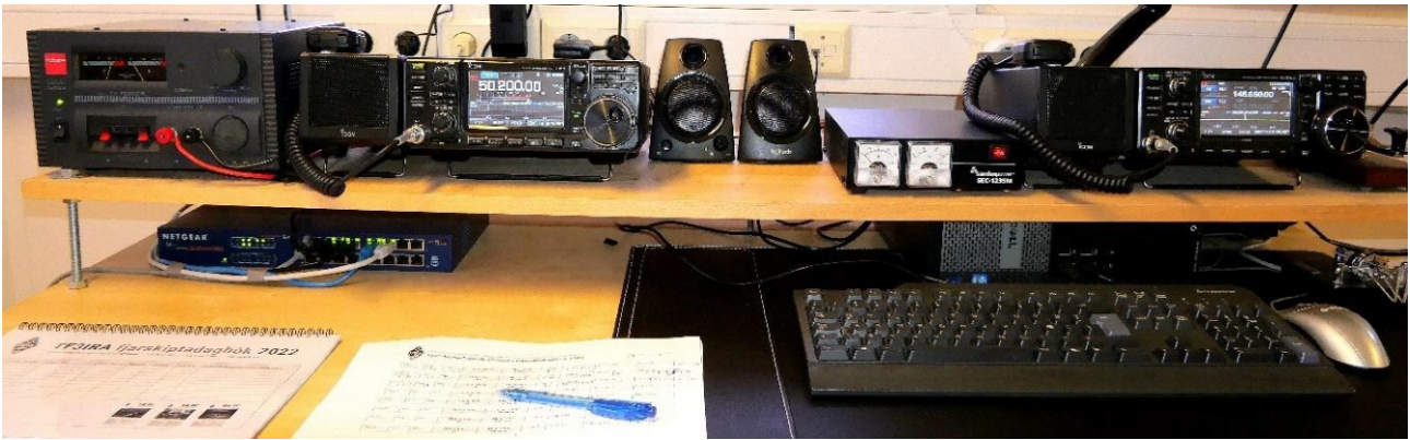
Icom IC-7300 100/100/50W HF/50/70 MHz stöð félagsins var notuð á 50 og 70 MHz SSB og Icom IC-9700 100/75/10W VHF/UHF lánsstöð var notuð á 144 og 433 MHz á FM og SSB. Ljósmynd: TF3JB.
