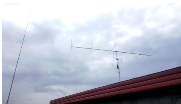
Glæsilegt 6 elementa LFA Yagi loftnet Hrafnkels Sigurðssonar TF8KY á 50 MHz er frá InnovAntennas. Ljósmynd: TF8KY.
