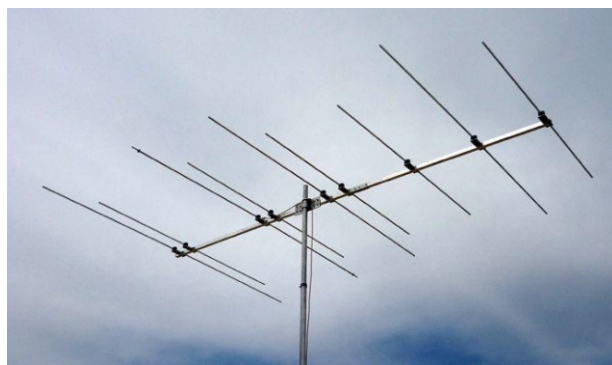
EAntenna 070-OWA9 er 9 elementa Yagi loftnet fyrir 50 og 70 MHz böndin. Ljósmynd: TF1EIN.
