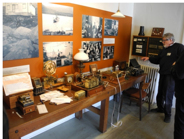
Mynd 5. Til vinstri er gatari til þess að gata strimla sem notaðir voru til að senda morse. Til hægri er nýrri búnaður þar sem gatari var tengdur við lykklaborð
