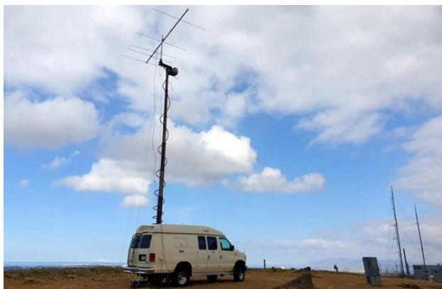
Glæsileg fjarskiptabífreidd Ólafs Arnar Ólafssonar TF1OL. Ólafur var QRV þessa viku sem TF1OL/P, m.a. frá Vatnsendahæð í Kópavogi. Loftnetið er LFA Yagi á 50 MHz frá InnovAntennas Ljósmynd: TF1OL.
