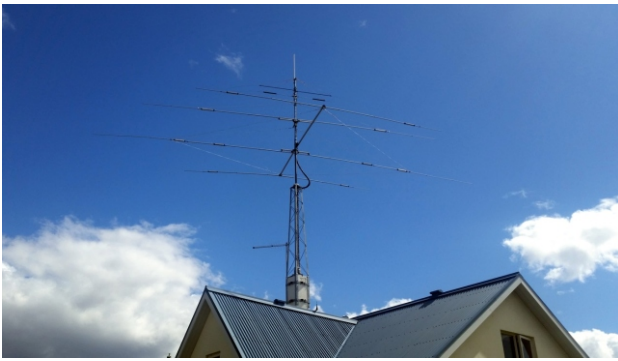
Lofnet TF5B eftir viðgerð í maí 2020. Fritzel FB-33, 3 staka Yagi lofnet fyrir 14, 21 og 28 MHz; Fritzel tvíþóll fyrir 10, 18 og 24 MHz; Hamstick tvíþóll (láréttur) fyrir 3.5 MHz; Hamstick tvíþóll (láréttur) fyrir 1.8 MHz og Diamond X-30 stangarlofnet fyrir 144/430 MHz. Ljósmynd: Brynjólfur Jónsson TF5B.
