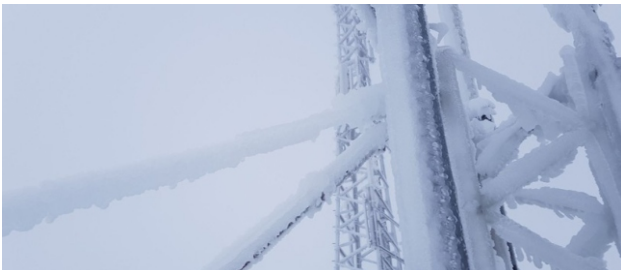
Virinn (fyrir ofan) er 1 mm lofnettsþráður fyrir viðtækið. Ísingin mældist 8 cm þykk og vetur rétt nýbyrjaður. Ljósmynd: Georg Kulp TF3GZ.
