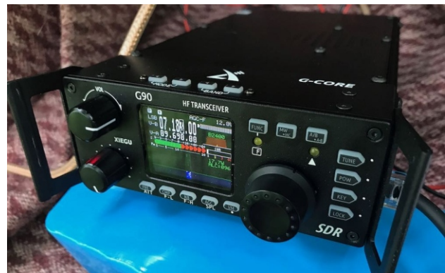
Xiegu G90 er 20W HF SDR sendi-/móttökustöð. Mynd: TF3JB.
