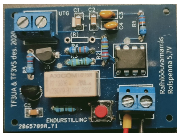
Mynd 2. Rásin komin á sérframleidda prentplötu. Hér sést reyndar 5,7V útgáfa hennar, sem er ætluð fyrir 6V rafhlöðu.
