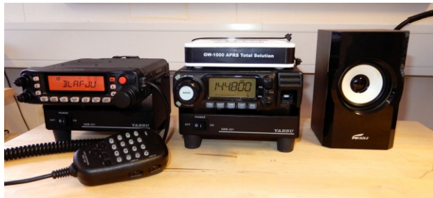
APRS stöð félagsins TF3IRA-1Ø er fyrir miðju á myndinni. Stöðin er Icom IC-208H, 5–55W VHF/UHF FM stöð. APRS búnaður: GW-1000 (APRS Total Solution) frá CG-Antenna. Mynd: TF3JB.
