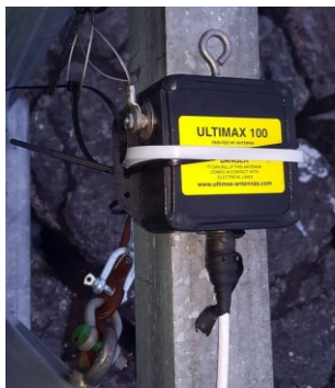
Unun frá Ultimax 100 er notuð til að lækka sýndarviðnámið í sæðipunkti fyrir viðtækið. Ljósmynd: Georg Kulp TF3GZ.
