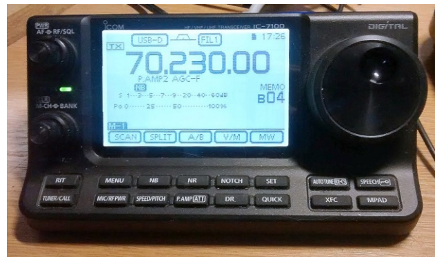
Myndin er af Icom IC-7100 HF stöð sem er á meðal nýrra stöðva sem eru m.a. búnar 70 MHz bandinu. Mynd: Icom UK.
