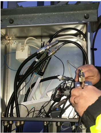
Tengikassinn fyrir KiwiSDR viðtækið í Bláfjöllum. Mynd: Georg Kulp TF3GZ.
