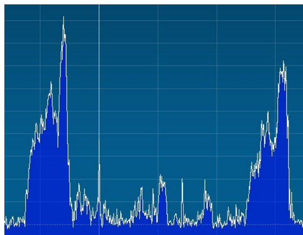
MYND 3. Mynd tekin af tveimur LSB merkjum á 40m. Sjá má að bassinn er mjög sterkur sem hluti af merkinu. Hver lóðrétt rúða er 5 dB í afli. Bassinn er vinstra megin í hvoru merki (LSB). Ljósmynd: TF1A
