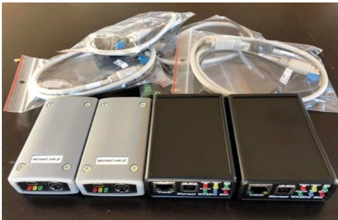
Microsat WX3in1 Mini APRS Digipeater/I-gate og PLXDigi – APRS Digipeater búnaðinum sem kostaður var af félagssjóði á starfsárinu gerður klár til uppsetningar. Ljósmynd: Magnús Ragnarsson TF1MT.
