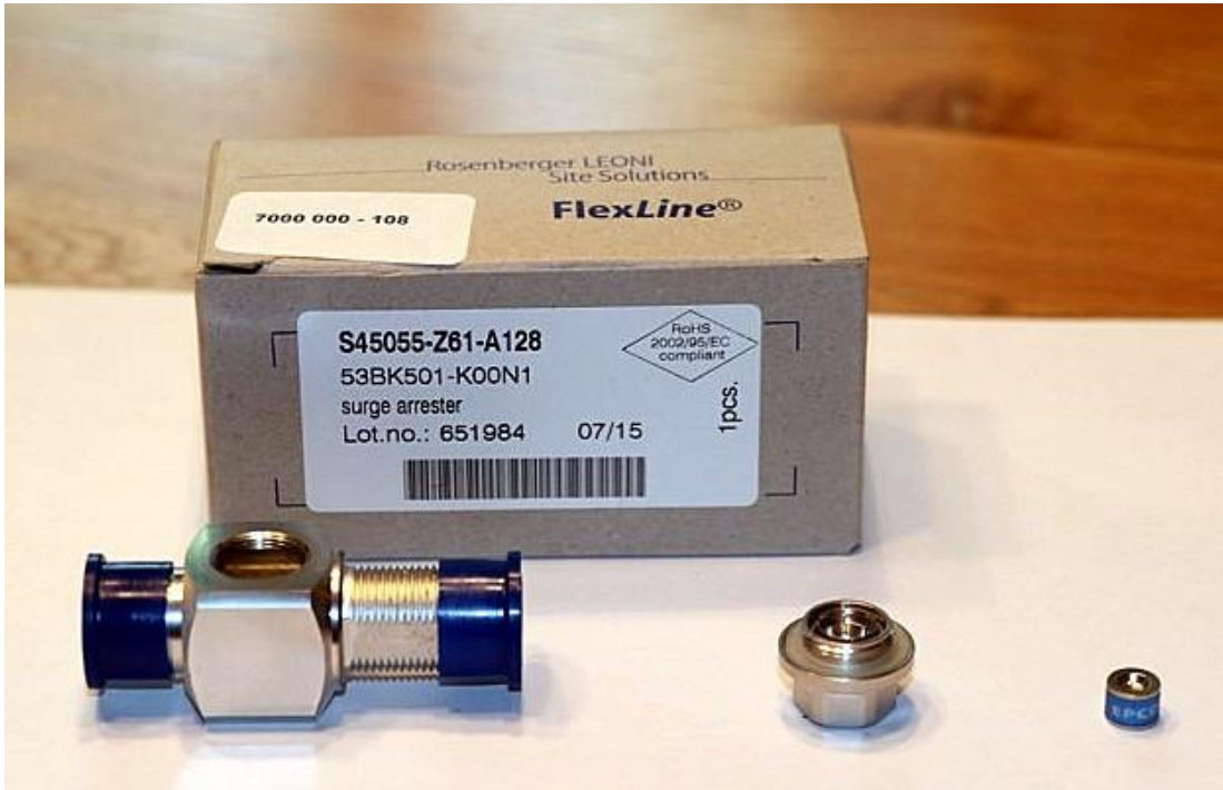
Á myndinni má sjá sýnishorn af eldingarvörum (sem allir eru sömu gerðar). Gasöryggið er sett í opna hólfið og þar á eftir er lokið skrúfað á. Ljósmynd: Gísli G. Ófeigsson TF3G.
