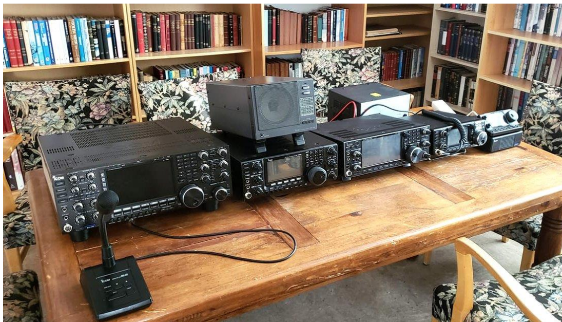
Fremst til vinstri: Icom SM-50 borðhljóðnemi. Þá Icom IC-7851, IC-9100, IC-7610, IC-7300 og IC-7100. Hátalarinn ofan á IC-9100 stöðinni er Icom SP-20. Til hægri á myndinni (fyrir aftan stöðvarnar) sést í bakhliðina á Diamond GSV3000 aflgjafanum. Ljósmynd: Ari Þórólfur Jóhannesson TF1A.
