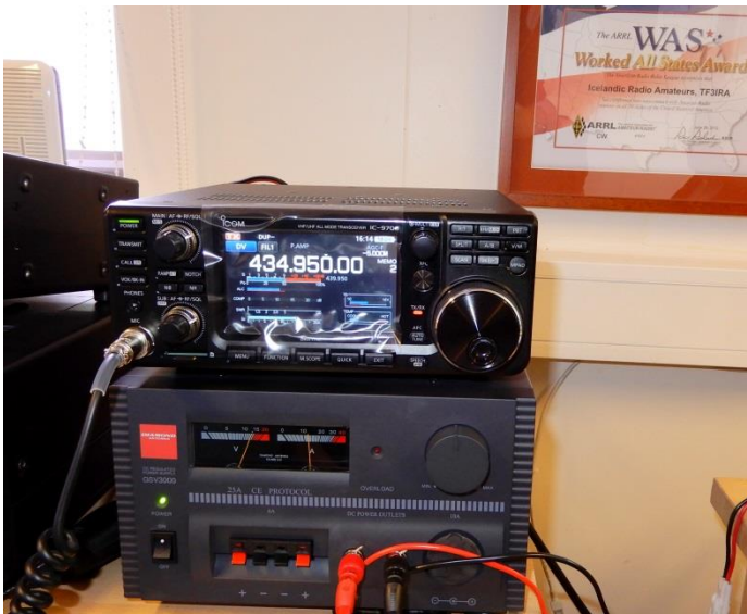
Myndin er af nýju Icom IC-9700 stöðinni. Til skýringar skal þess getið að skjámyndin sem sést á stöðinni er aðeins ein af mörgum sem er í boði. Bandsjáin er t.d. ekki sýnd á þessari mynd. Ljósmynd: TF3JB.
