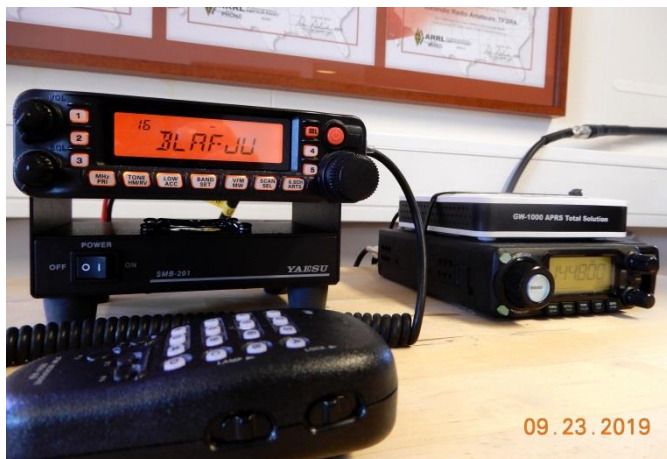
YAESU FT-7900E stöðin og SMB-201 borðfestingin eftir að búið var að ganga frá samsetningu. Umrædd kælivifta og gúmmífætur sjást vel á myndinni. Þess má geta, að SMB-201 fylgir sérstakur aflagji.
