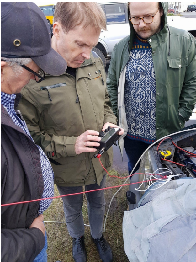
TF3DT, TF3Y og Davíð. Yngvi stillir nýju Elecraft KX2 stöðina. Hún er 10W á 80-10 metrum; CW, SSB og stafrænum tegundum útgeislunar. Yngvi hafði strax nokkur DX sambönd á morsi. Ljósmynd: TF3AWS.
