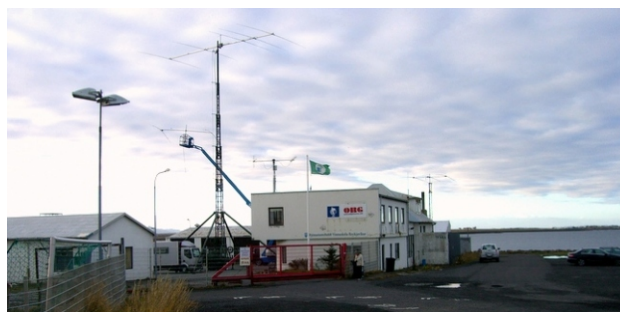
Loftnet til ráðstöfunar í SAC SSB keppninni 2012 voru, frá hægri til vinstri: SteppIR 3E 3 staka Yagi loftnet á 10, 15 og 20 metrum í 15 metra hæð; Cushcraft 40-2CD einsbands Yagi loftnet á 40 metrum í 20 metra hæð og OptiBeam OB-5 einsbands Yagi loftnet á 20 metrum í 27 metra hæð. Ljósmynd: Jónas Bjarnason, TF3JB.
