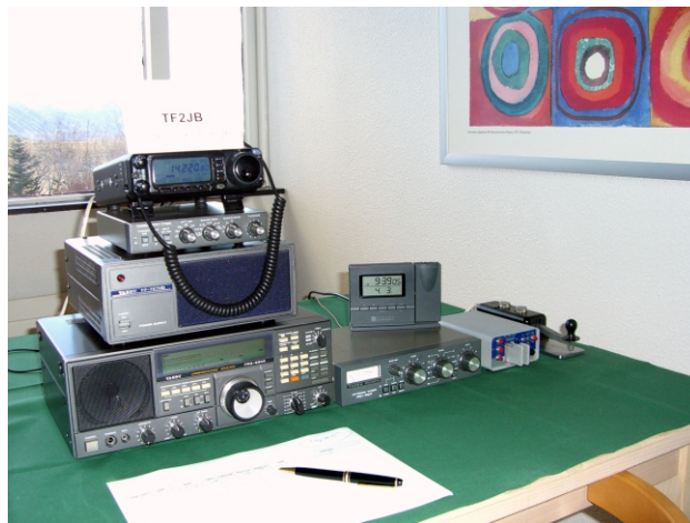
Fjarskiptaaðstaða TF2JB 2007. Stöðin er Yaesu FT-100 fyrir HF+6M og 2M+70cm (í láni frá TF1JI). Yaesu FC-707 lofnetsaðlögunarrásin er undir klukkunni. Viðtækið er Yaesu FRG-8800 ásamt Yaesu FRT-7700 lofnetsaðlögunarrás milli stöðvar og aflgjafa. Aflgjafinn er Yaesu FP-757HD með innbyggðum hátalara. Morslyklarnir eru ETM-4C frá H. Samson og M.P. Pedersen.
